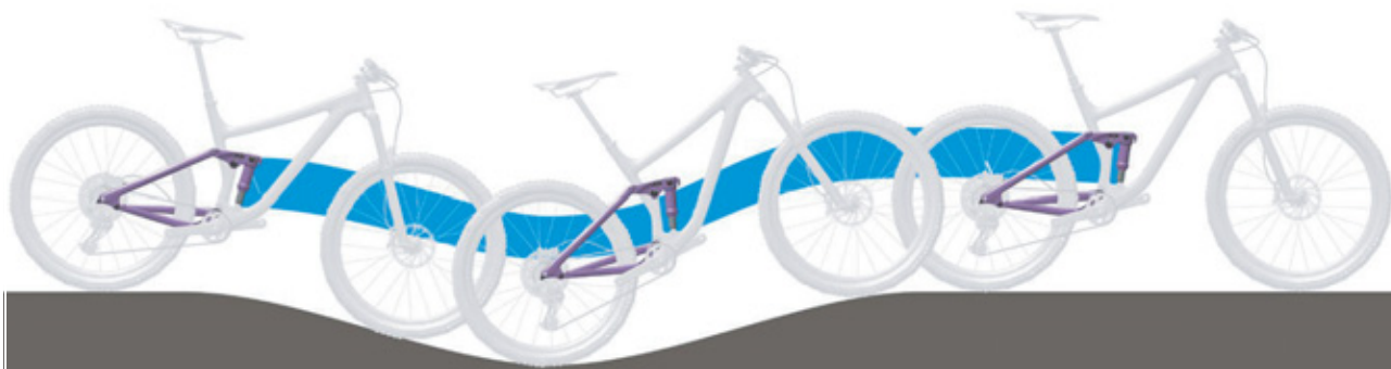
Illustration 97 : Comportement optimal de l'amortisseur arrière en terrain vallonné
