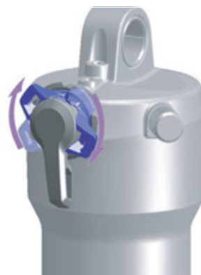
Illustration 100 : Régler le dispositif de réglage de la compression sur un niveau plus dur
