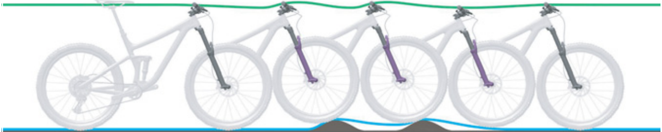
Illustration 136 : Détente trop lente de la fourche de suspension
