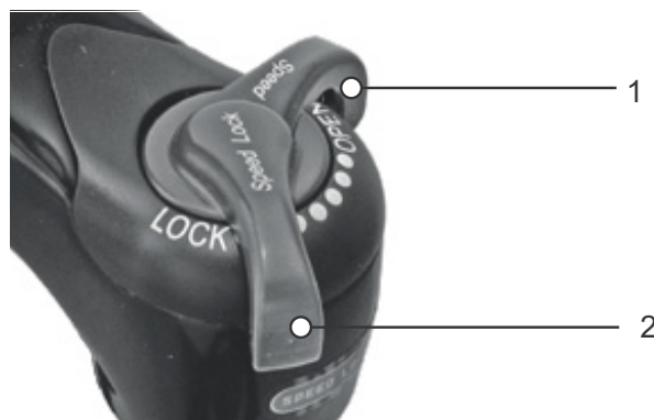
Illustration 122 : Amortisseur de compression Suntour en position ouverte (1) et fermée (2)
