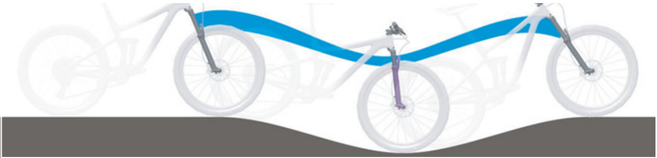
Illustration 138 : Suspension trop souple de la fourche de suspension dans les côtes
