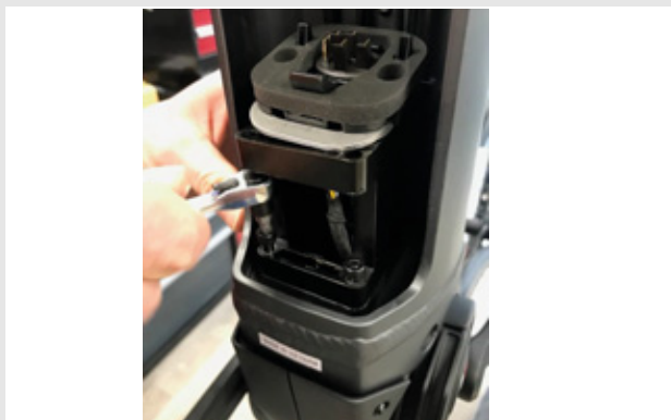
Illustration 36 : Retirer les vis à 6 pans de 4 mm
