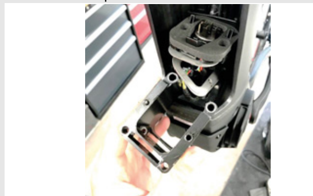
Illustration 38 : Retirer l'adaptateur PowerTube
