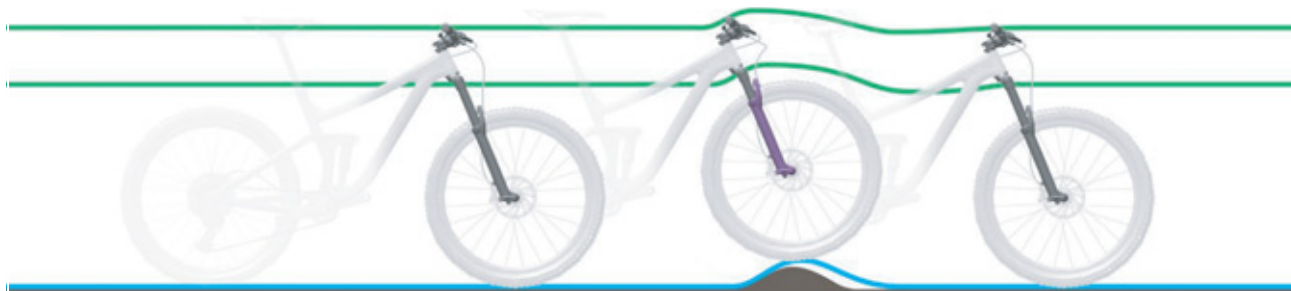
Illustration 140 : Amortissement trop dur de la fourche de suspension en cas d'irrégularités
