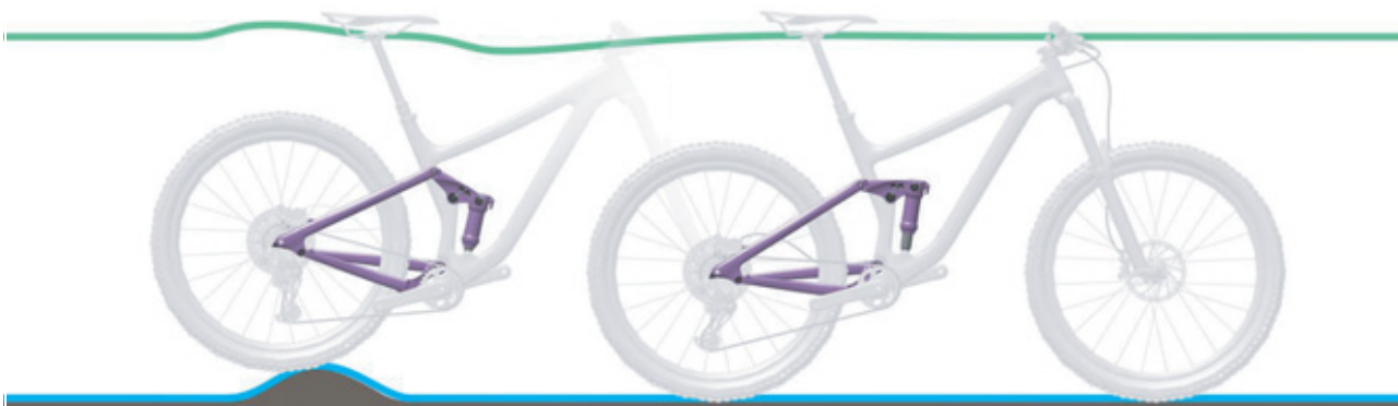
Illustration 98 : Comportement optimal de l'amortisseur arrière sur des irrégularités
