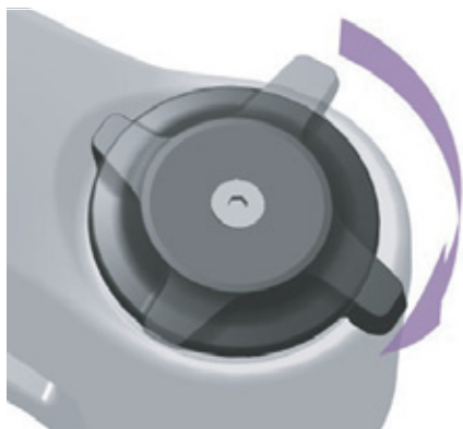
Illustration 139 : Régler le dispositif de réglage de la compression sur un niveau plus dur
