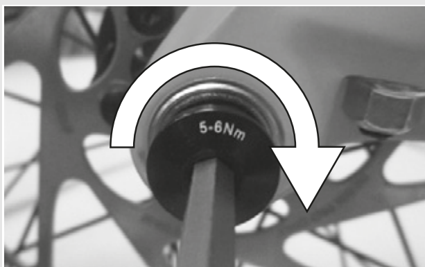
Illustration 51 : Serrer la vis de blocage
