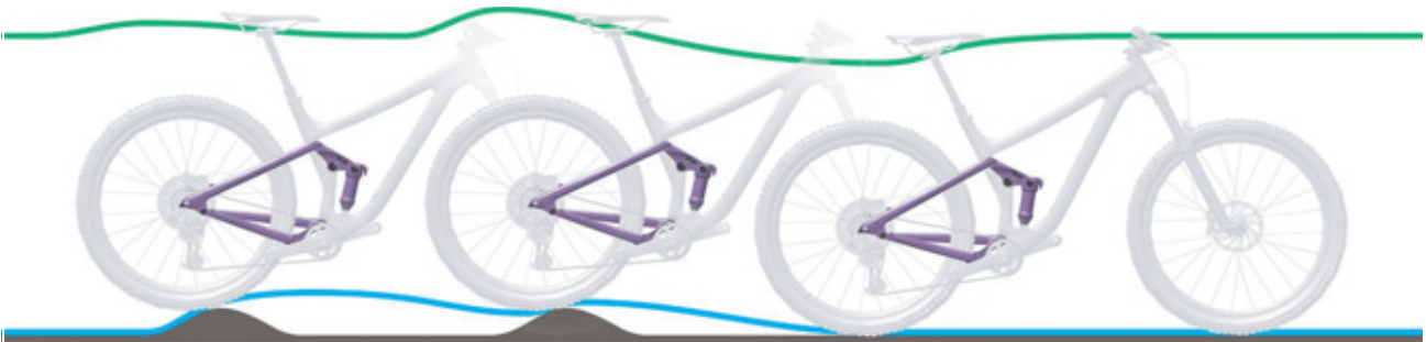
Illustration 144 : Détente trop lente de l'amortisseur arrière
