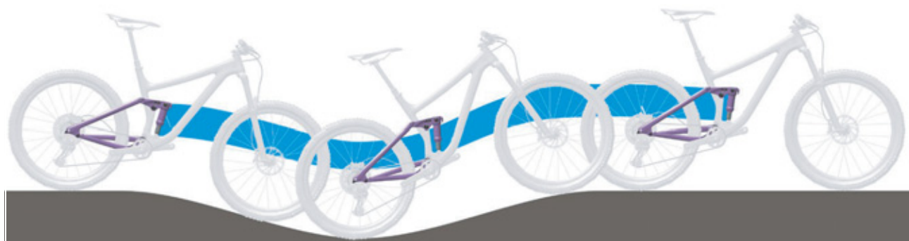
Illustration 11 : Comportement optimal de l'amortisseur arrière en terrain vallonné
