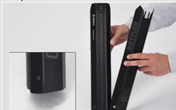
Illustration 43 : Enfoncer le capot de batterie sur la batterie
