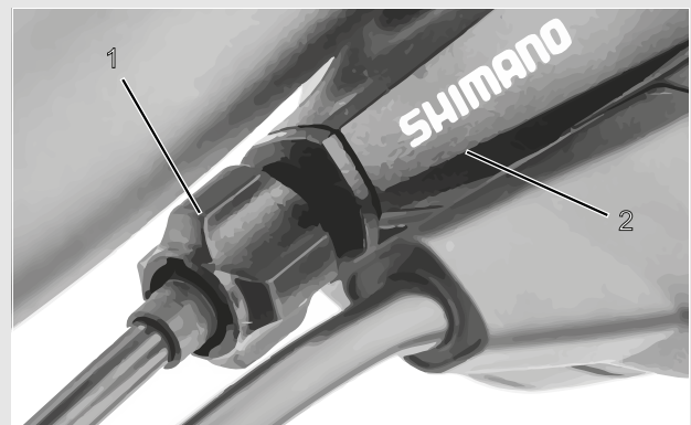
Illustration 131 : Douille de réglage (1) du changement de vitesse à un câble actionné par câble avec boîtier de manette de vitesse (2), exemple
