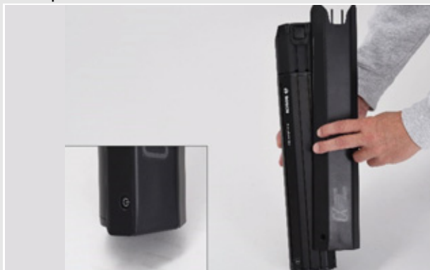
Illustration 47 : Enfoncer le capot de batterie sur la batterie
