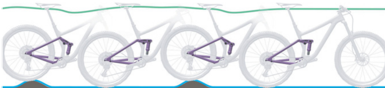
Illustration 10 : Comportement optimal de l'amortisseur arrière
