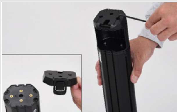
Illustration 46 : Visser la plaque de montage de la batterie
