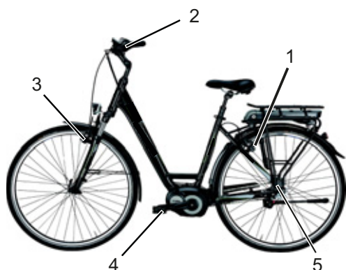
Illustration 18 : Système de frein avec un frein à rétro pédalage, exemple
