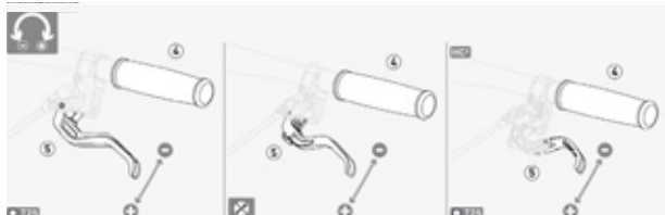
Illustration 77 : Régler la garde d'un levier de frein à disque Magura
