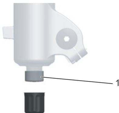
Illustration 92 : Dispositif de réglage de la détente FOX (1) sur l'extrémité de fourche
