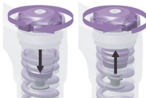
Illustration 82 : Serrer et desserrer l'anneau de réglage de la prétension.
