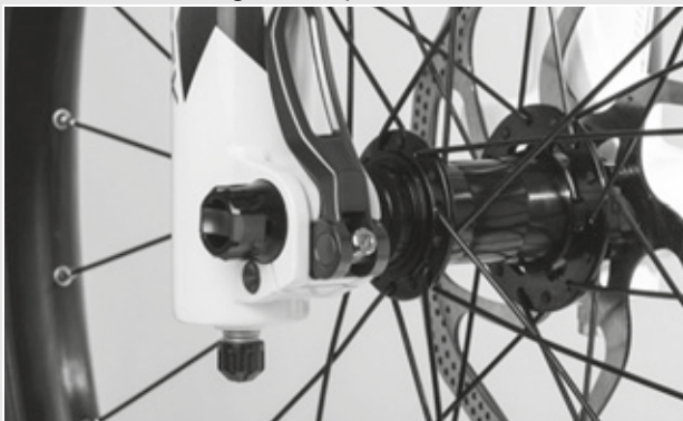
Illustration 58 : Position parfaite du levier de serrage
