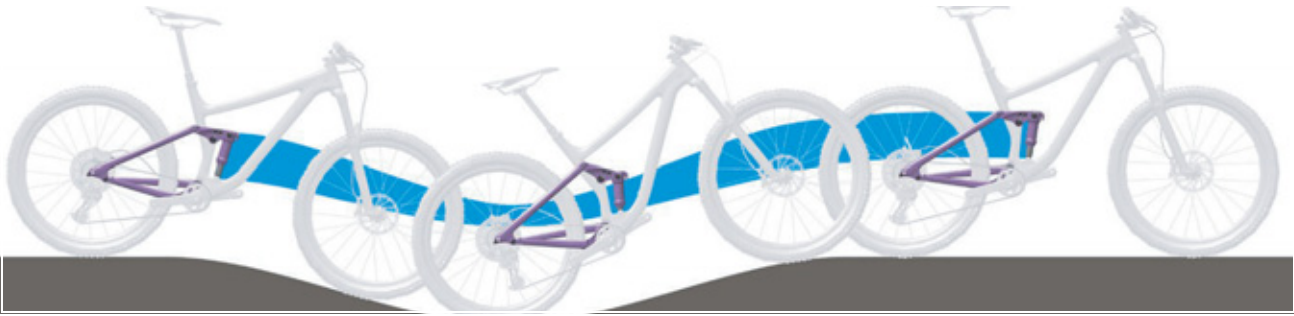
Illustration 146 : Suspension trop souple de l'amortisseur arrière dans les côtes
