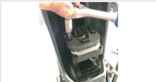
Illustration 35 : Desserrez les vis du logement de batterie
