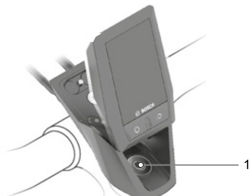
Illustration 111 : Position de la vis du jeu de direction
