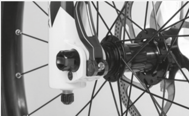
Illustration 129 : Régler la force de serrage de l'attache rapide
