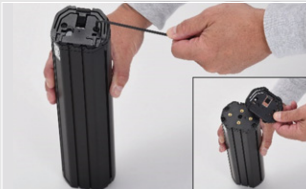
Illustration 44 : Démontage de l'interface supérieure
